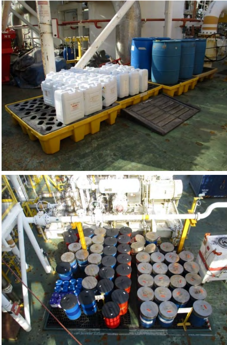
รูปที่ 2.6-18: ตัวอย่างพื้นที่จัดเก็บสารเคมีที่ใช้ในกระบวนการผลิตบนแท่นผลิตอาทิตย์
