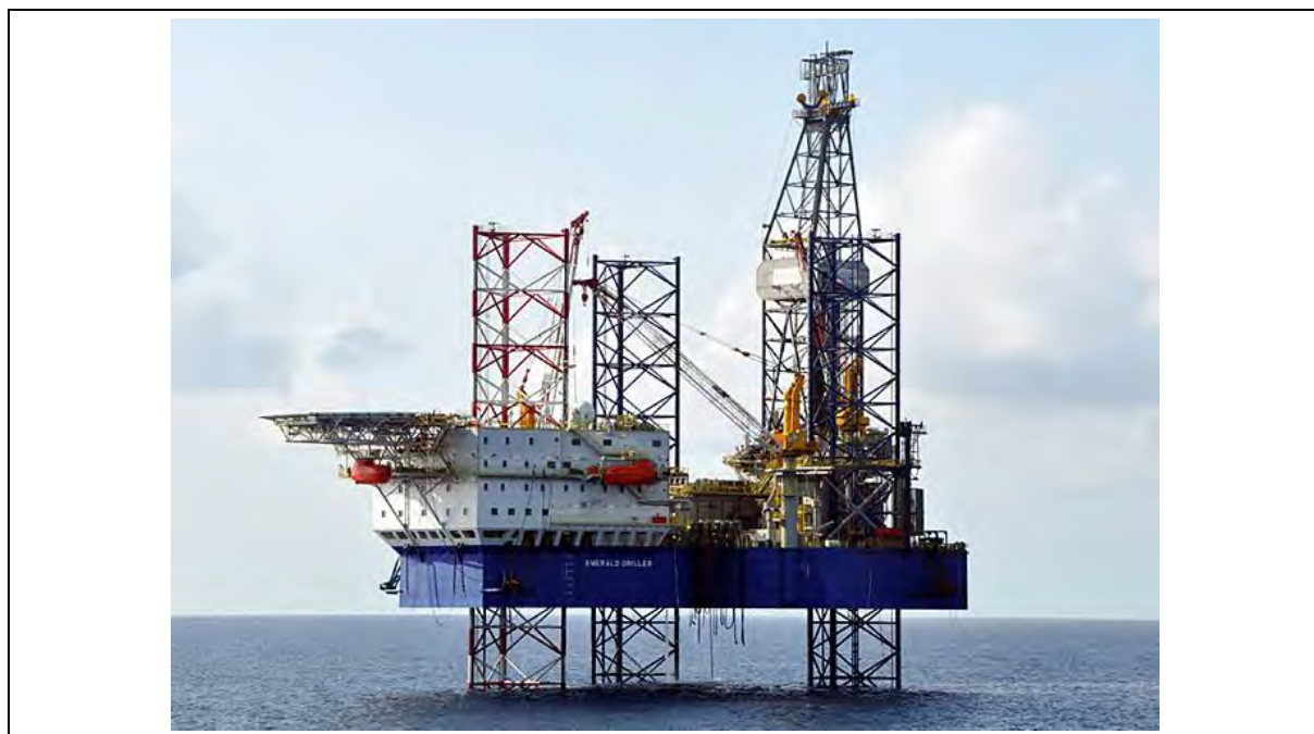
รูปที่ 2.5-4: ตัวอย่างของแท่นเจาะชนิดหยั่งตืดพื้นทะเลแบบยกตัวได้
