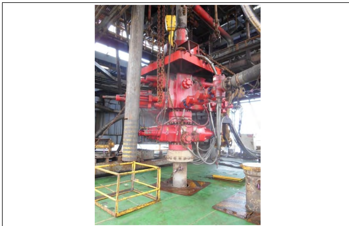
รูปที่ 2.5-6: ตัวอย่างอุปกรณ์ป้องกันการพลุ่ง (Blowout Preventer หรือ BOP)
